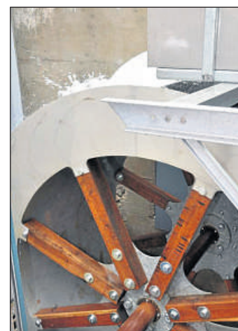
Unermüdlich: Wasserrad am Mühlgraben für Öko-Strom.
