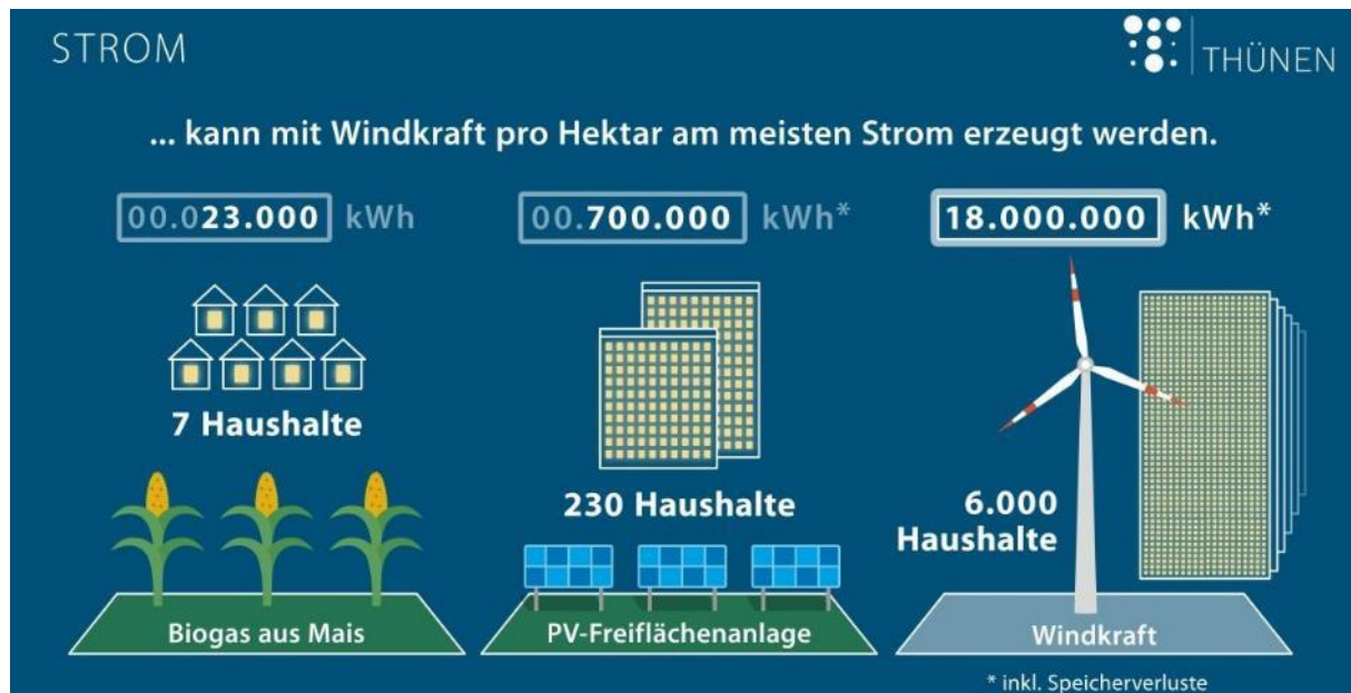
Abbildung 20: Flächenbezogener Energieertrag (Biogas, Photovoltaik und Windenergie) 27
